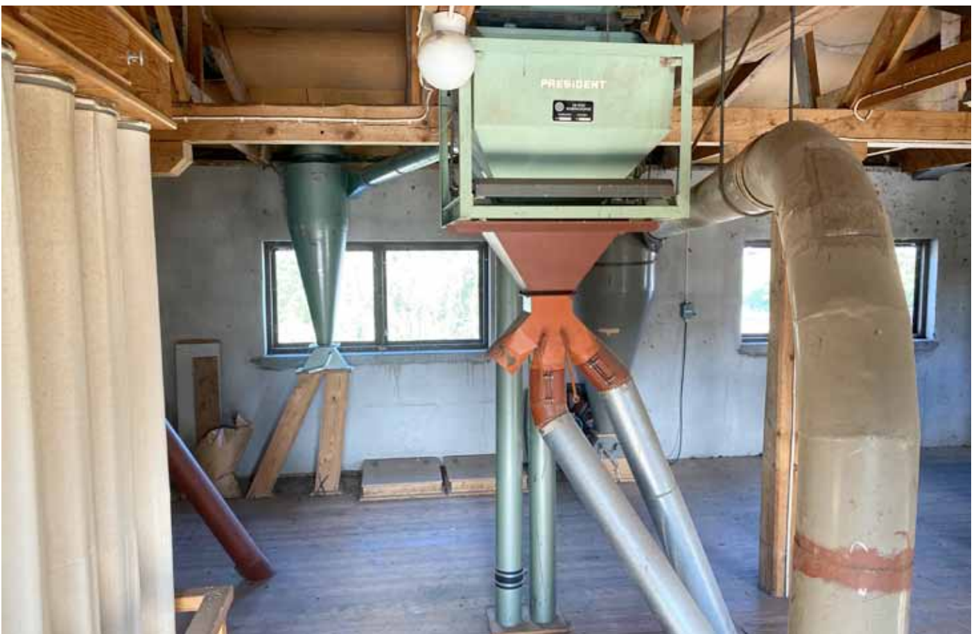
T.v. strumpor till aspiratör, t.h. våg och i bakgrunden två cykloner.
